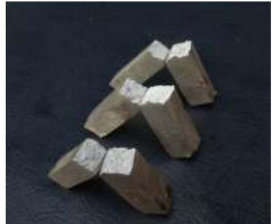
Gambar 10 Spesiemen Hasil Pengujian Ketangguhan
