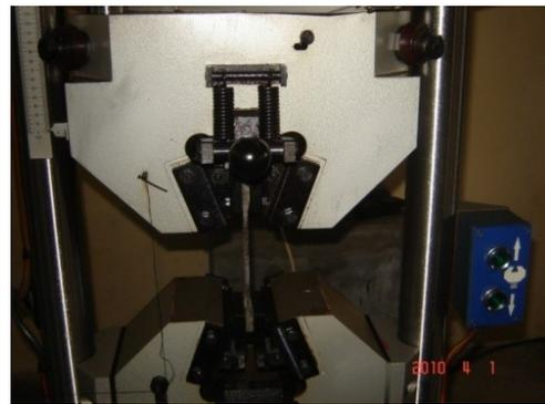
**Gambar 5:** Pemasangan specimen pada alat uji tarik
