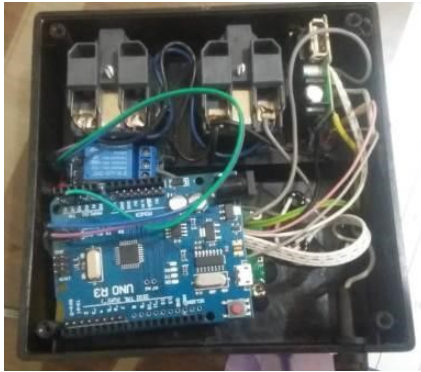
Gambar 6: Hasil Perancangan BMP085 dan Mikrokontroler Arduino
