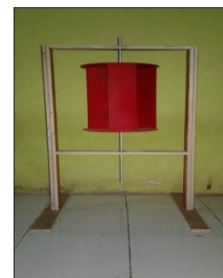
Gambar 2.3. Kincir Angin sumbu vertical tipe sudu 90° 3 sudu
