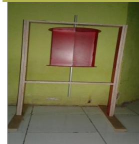
Gambar 2.2. Kincir Angin sumbu vertical tipe sudu 90° 2 sudu
