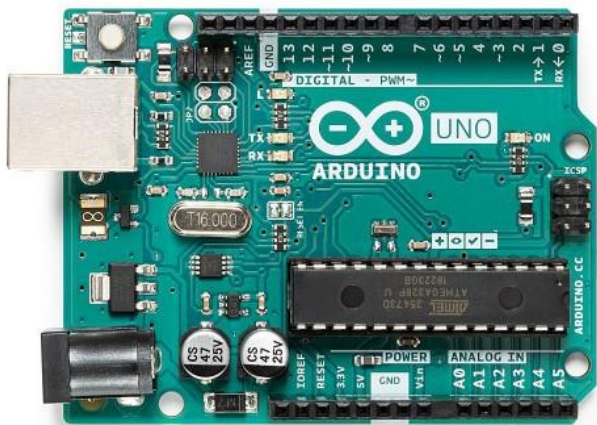
Gambar 2 Mikrokontroler Arduino Uno
