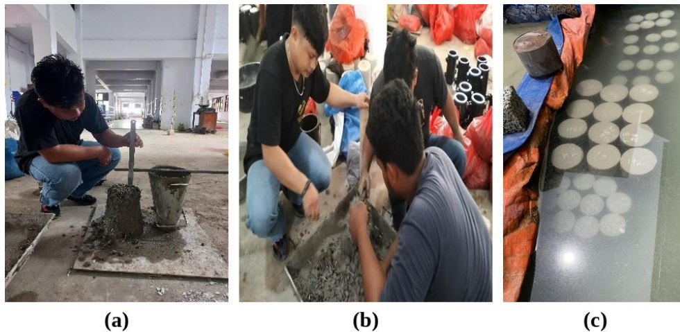
Gambar 3. Pembuatan Benda Uji: (a) Uji Slump; (b) Pencampuran dan Pencetakan; (c) Perawatan dengan Perendaman
