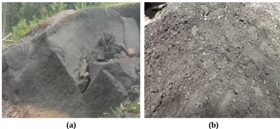
Gambar 1. Bahan Substitusi: (a) Batu Basalt di Saloso; (b) Serbuk Batu Basalt Sisa Pemahatan
