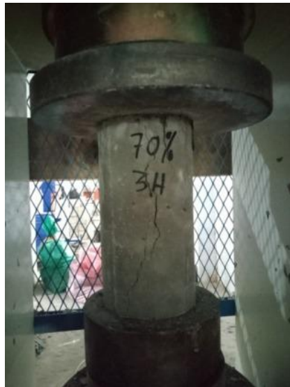
Gambar 2. Pengujian Kuat Tekan Benda Uji Silinder
