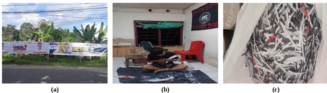
Gambar 1. Bahan Serat Limbah Spanduk: (a) Spanduk Bekas sebagai Bahan Baku; (b) Proses Pemotongan Spanduk; (c) Serat Limbah Spanduk Siap Pakai
