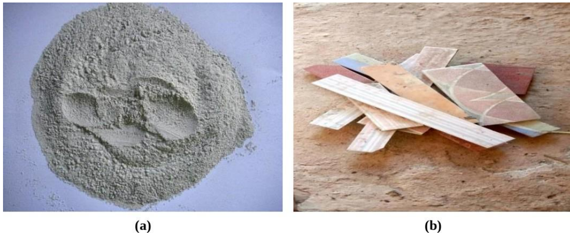
Gambar 1. Bahan Tambah yang Digunakan: (a) Zeolit Alam; (b) Limbah Keramik
