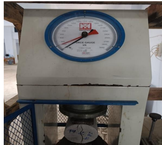
Gambar 3.1. Pengujian kuat tekan dan kuat tarik belah
