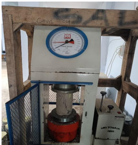
Gambar 3.1. Pengujian kuat tekan dan kuat tarik belah
