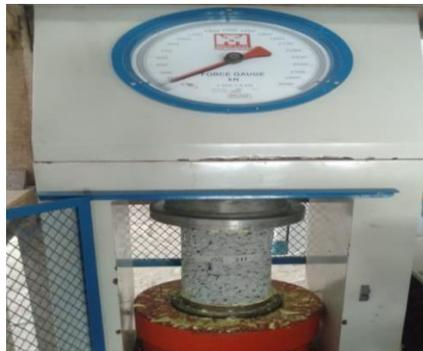
Gambar 2. Pengujian Kuat Tekan Beton Porus
