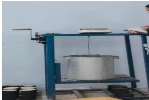
Gambar 3. Pengujian Porositas Beton Porus
