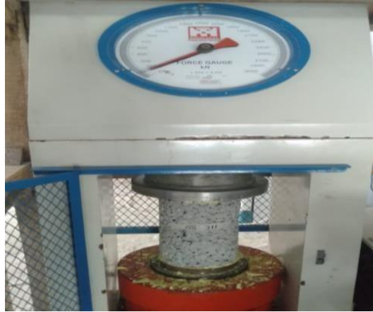
Gambar 2. Hasil Pengujian Kuat Tekan Beton Porous
