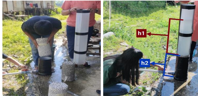
Gambar 5. Pengujian permeabilitas beton porous umur 28 hari
