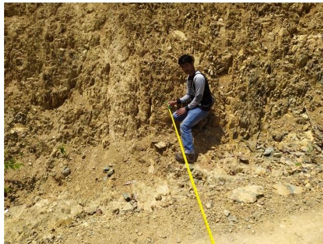
Gambar 2. Pengukuran Jarak Pandang Bebas di Lapangan ( E_{Lapangan} )
