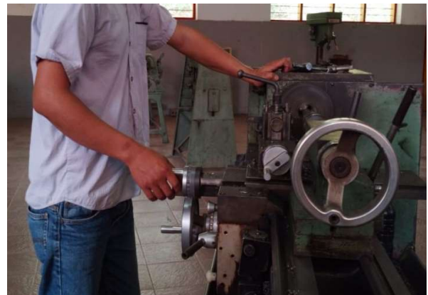
Gambar 2: Penyetelan Gerak Makan dan Kedalaman Potong pada mesin bubut konvensional.
