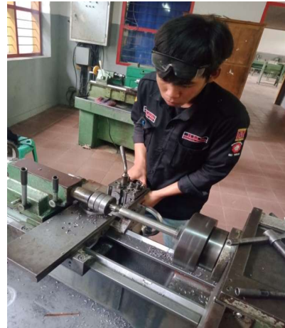
Gambar 2: Penyetelan sudut pahat dan pemasangan benda kerja pada mesin bubut konvensional.
