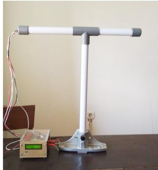
**Gambar 4:** Sensor LVDT
